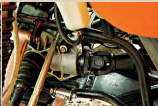
Наконечники рулевых тяг, в отличие от карданных валов, идущих от раздатки к мостам, не вызывают ощущение монументальности. И ломаются по резьбе!
