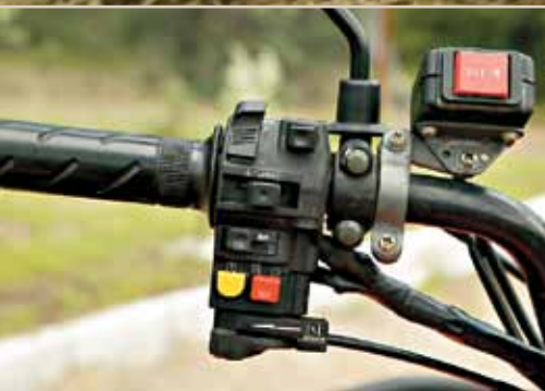
Этажерка пульта начинается кнопками управления лебедкой и заканчивается рычажком подсоса
