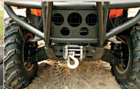
Лебедка и выглядит внушительно, и тянет уверенно. Весь передний кенгурятник сделан из металла, никакого пластика. Внушает!
