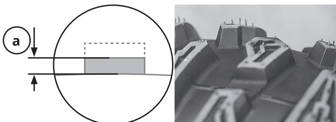
Периодически проводите осмотр износа протектора шины. Когда остаточная высота протектора (a) будет меньше 3 мм, замените шину.
