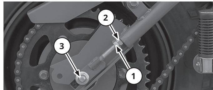
1. Приподнимите заднее колесо над землей, разместив под рамой опору. Установите мотоцикл на стояночный тормоз.
