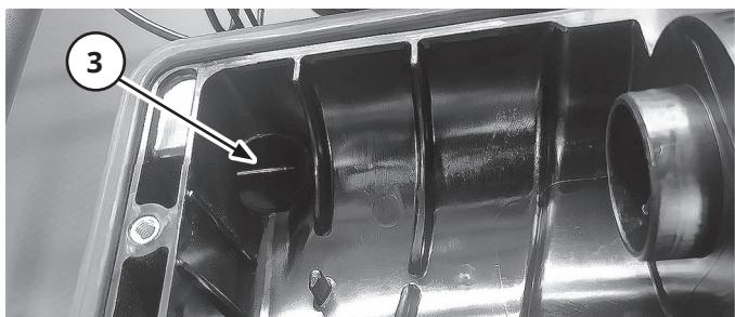
Очищайте корпус воздушного фильтра и фильтрующий элемент не реже чем через каждые 25 часов эксплуатации или ежегодно, а также при обнаружении грязи в резиновом накопителе.
