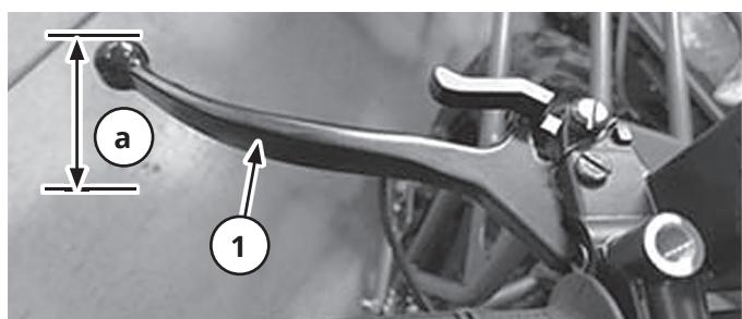
Проверьте уровень тормозной жидкости, состояние и износ тормозных колодок, если свободный ход рычага слишком большой.
