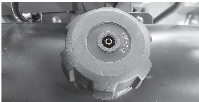
Чтобы открыть крышку топливного бака, открутите её против часовой стрелки.
