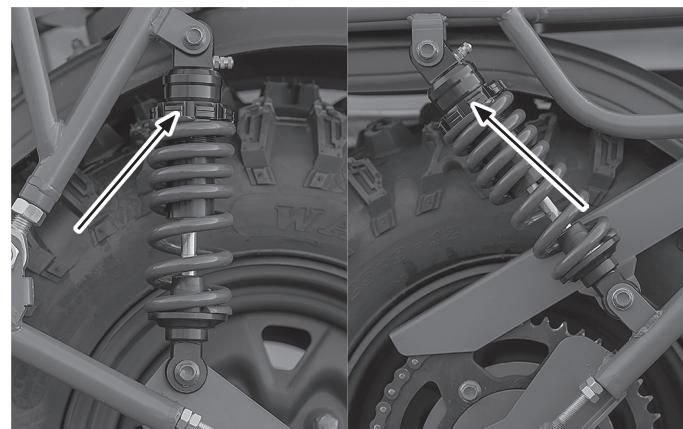
Преднатяг пружины амортизатора может быть отрегулирован под индивидуальные требования водителя и дорожные условия.
