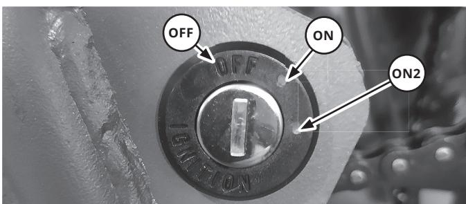
❖ **OFF:** Зажигание выключено. Ключ может быть удалён в этом положении.
