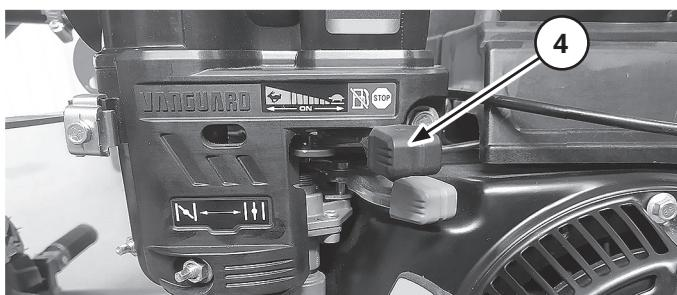
Топливный кран открыт, когда рычаг находится в положении **OFF**. Топливный кран перекрыт, когда рычаг находится в положении **STOP**.
