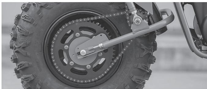
1. Проверьте прогиб нижней или верхней петли передней цепи в средней части между звёздочками. Цепь считается правильно отрегулированной, если прогиб составляет 0–5 мм в самом натянутом положении и 10–15 мм в самом прослабленном.
