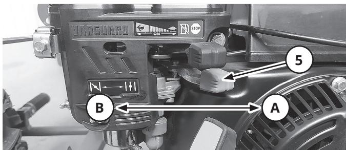
Рычаг воздушной заслонки (5) расположен на двигателе под воздушным фильтром. При рычаге управления воздушной заслонкой в положении (A) — заслонка открыта, используется при движении мотоцикла.
