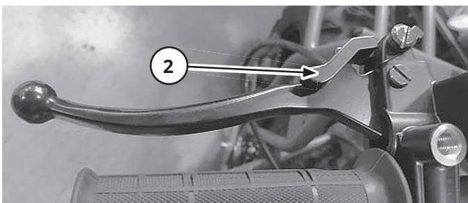
Чтобы отключить стояночный тормоз, нажмите на рычаг тормоза.
