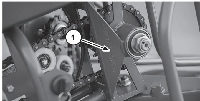
Номер продублирован на заводской табличке, наклеенной на поперечину рамы.
