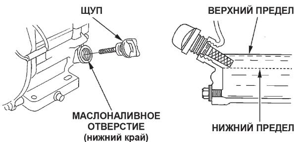
1. Снимите щуп горловины и протрите его.
