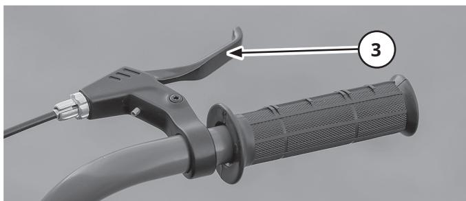
Рычаг газа (3) расположен на правой стороне руля. Во время работы двигателя перемещение рычага (3) газа изменяет скорость движения мотоцикла.
